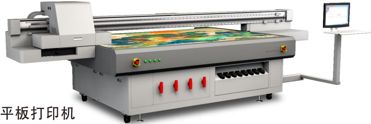
2.44米 × 1.22米打印幅面UV平板打印机
