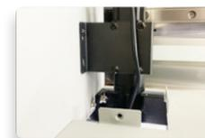
CCD对位：采用工业摄像头，精准识别，快速对位。图像偏移误差小于0.2mm。
